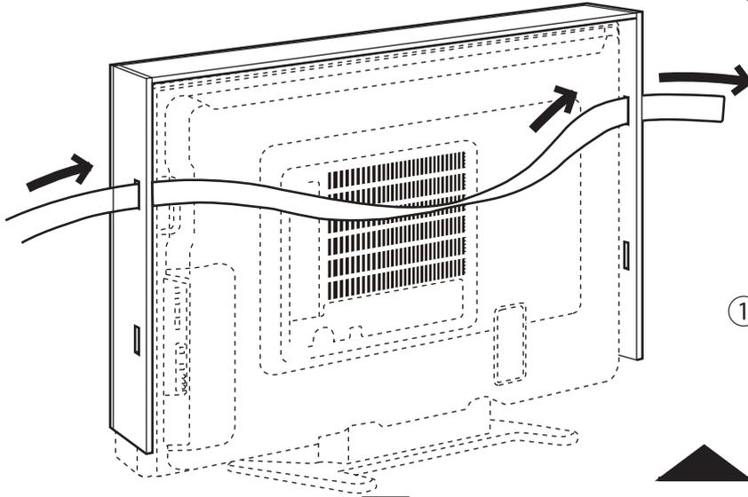
①側面にある穴に、外側からベルトを差し込み、反対側の穴を通し、外に出します。
