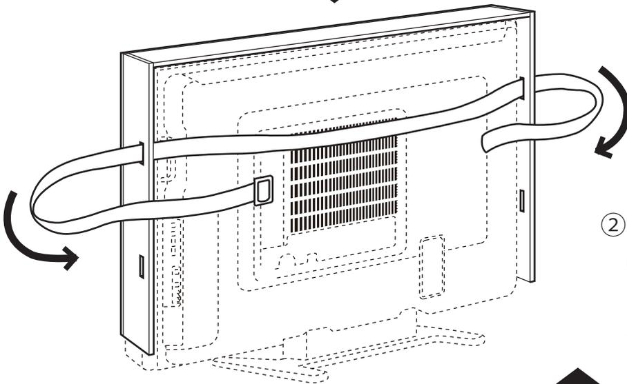
②四角のカンが付いている側のベルトの先と、穴を通したカンが付いていない側のベルトの先を近づけます。
